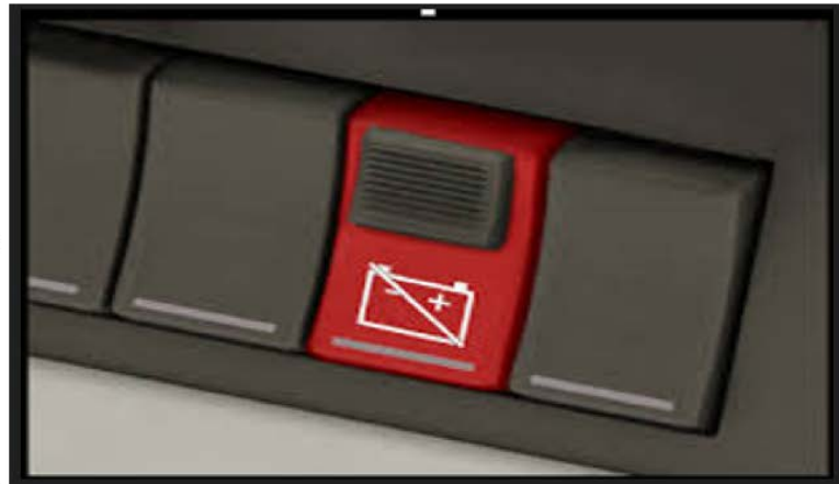
Desconnector de bateria exterior i desconnector a l'interior de la cabina
