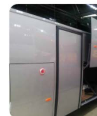
Comandament d'emergència exterior posterior
