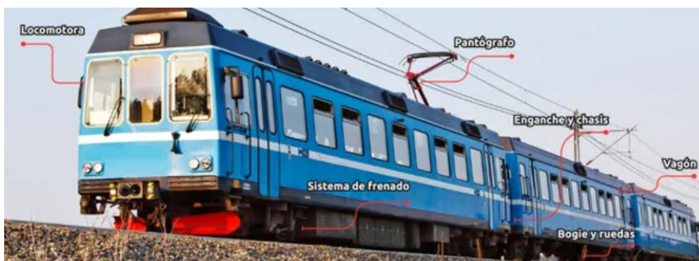
Esquema amb les principals parts d'un tren
