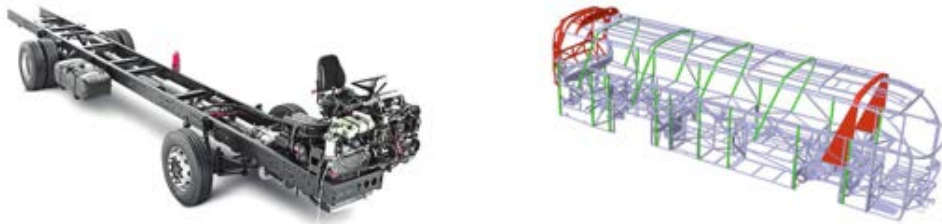
Bastidor i superestructura d'un autobús
