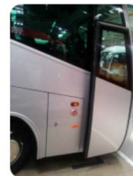
Comandament d'emergència exterior davanter
