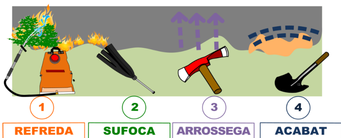
Posicions maniobra d'extinció amb eines manuals
