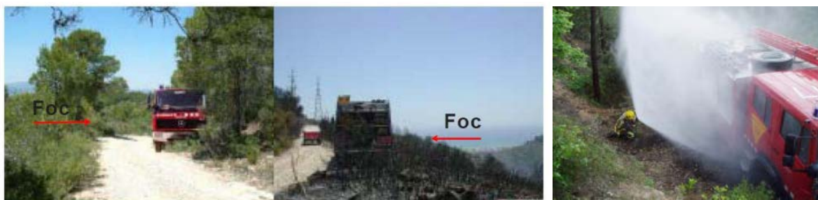
Maniobra en cas d'atrapament d'autobomba
